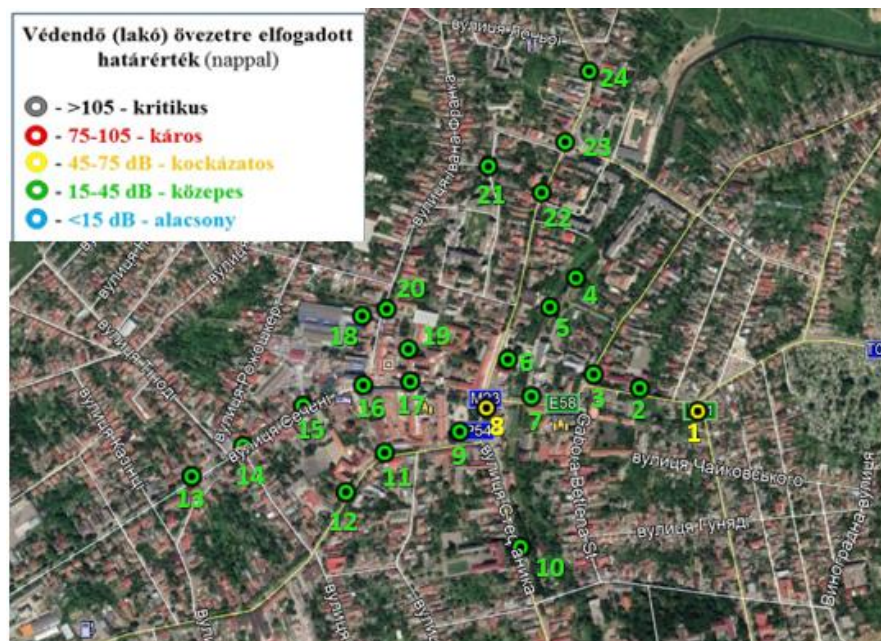
24. ábra. A zajszint átlagos mértéke (2021.04.23. összesített) Beregszász központi részén, a védendő (lakó) övezetre elfogadott nappali határérték alapján
