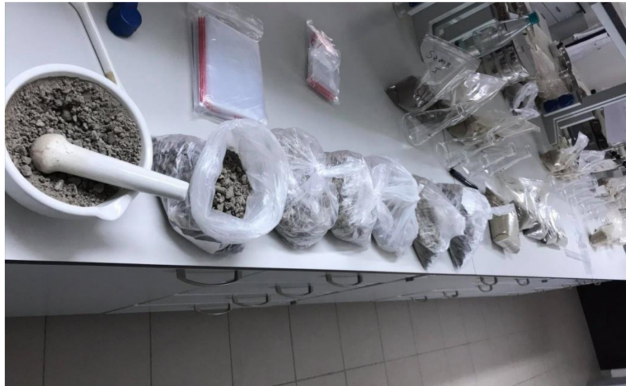
8 sz. ábra A talaj előkészítése az Arany-féle kötöttségi szám meghatározásához
