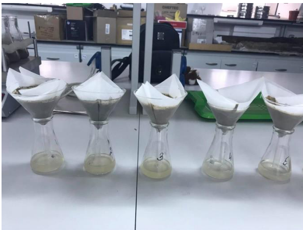
11 sz. ábra A talajminták vezetőképességének vizsgálata
