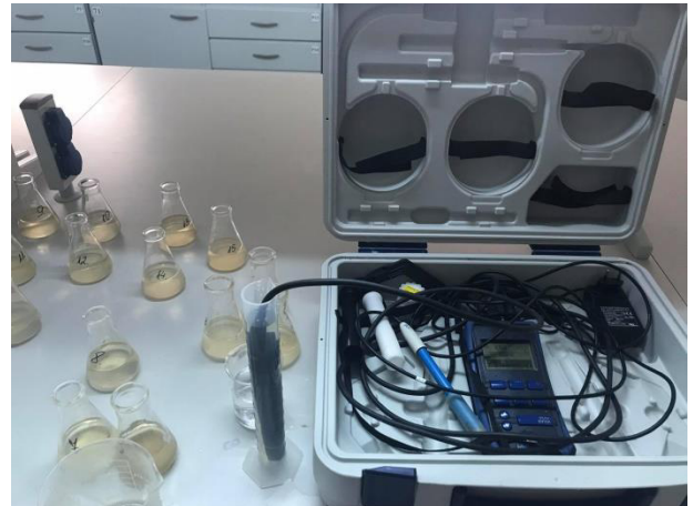
11 sz. ábra A talajminták vezetőképességének vizsgálata
