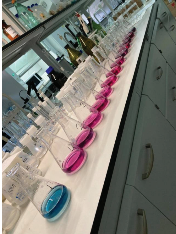
5. ábra. A komplex titrálás előtti állapota (Forrás: Saját készítésű fotó)
