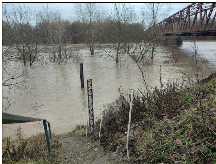
5. ábra: A tiszaujlaki lapvízmércék nagyobb vízállás idején (saját felvétel)
