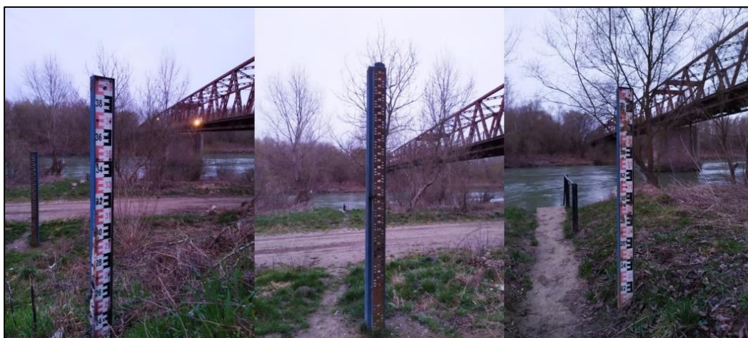
4. ábra: A tiszaújlaki lapvízmércék kisvíz esetén (Saját felvétel)
