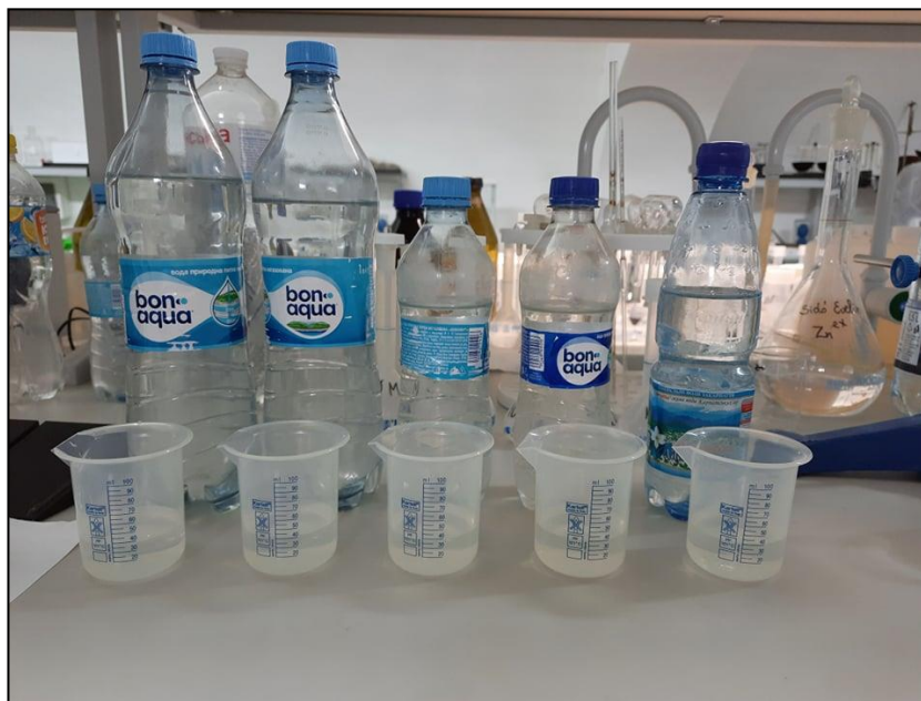
15. ábra. Az előkészített minták fele a nitrát tartalmuk meghatározásához (Saját felvétel, 2021).
