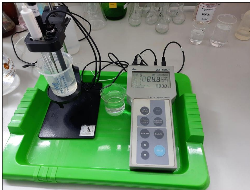
16. ábra. A nitrát mérésének folyamata (Saját felvétel).
