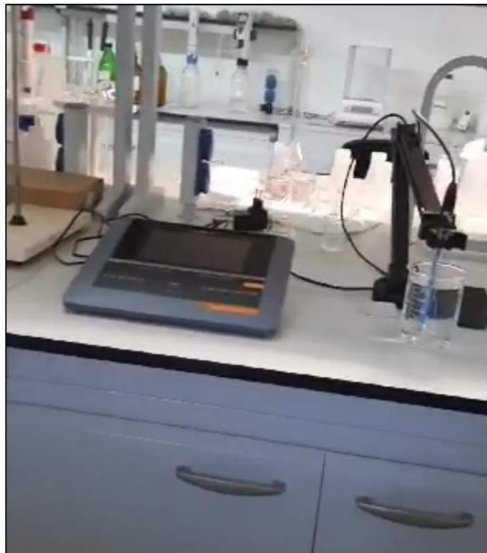
14. ábra. A pH és vezetőképesség mérő műszer (Saját felvétel, 2021).
