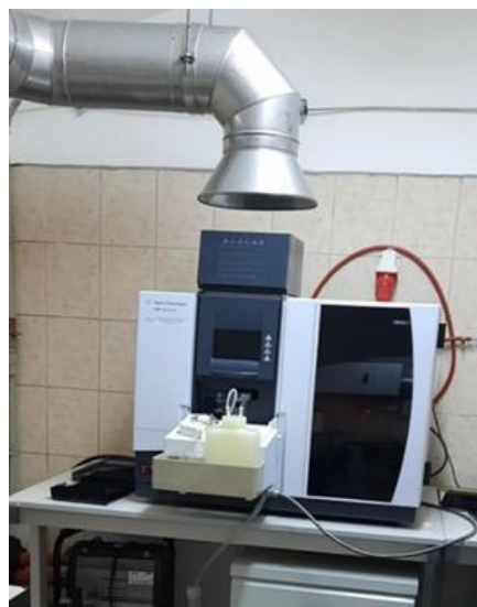
7. ábra. Agilent Technologies 240 típusú atom-abszorpciós spektrofotométer (Forrás: Saját felvétel)
