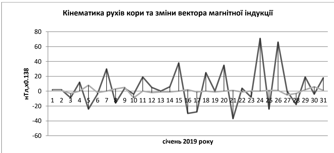
Рис. 3. Кінематика рухів кори(діаграма сірого кольору) та зміни вектора магнітної індукції( крива чорного кольору) в Закарпатському внутрішньому прогині за січень 2019 року.
