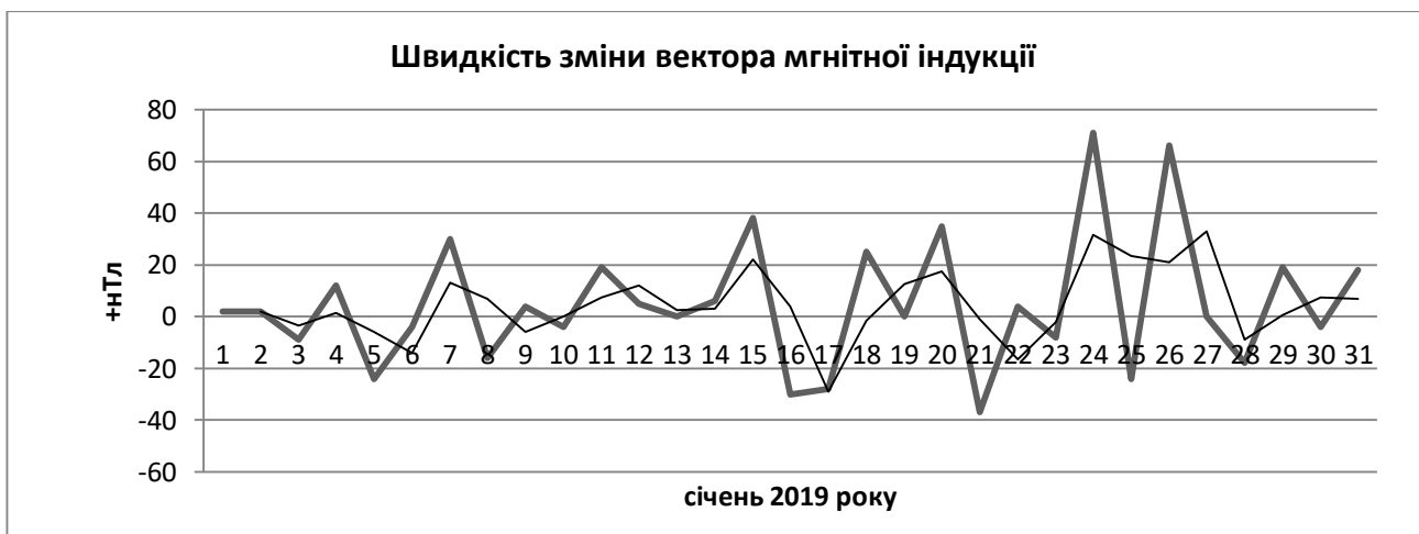
Рис. 2. Швидкість зміни вектора магнітної індукції на Режимній геофізичній станції „Тросник” за січень 2019 року.
