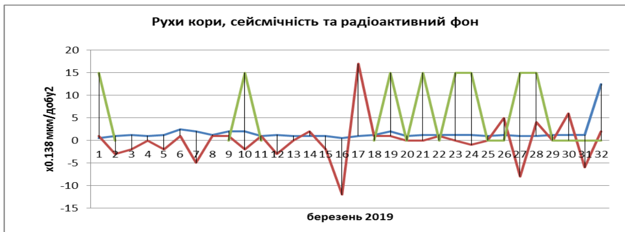
Рис. 9. Рухи кори( червоного кольору), сейсмічність регіону( діаграма зеленого кольору), радіоактивний фон ( крива синього кольору) в березні 2019 року. Закарпатський внутрішній прогин.
