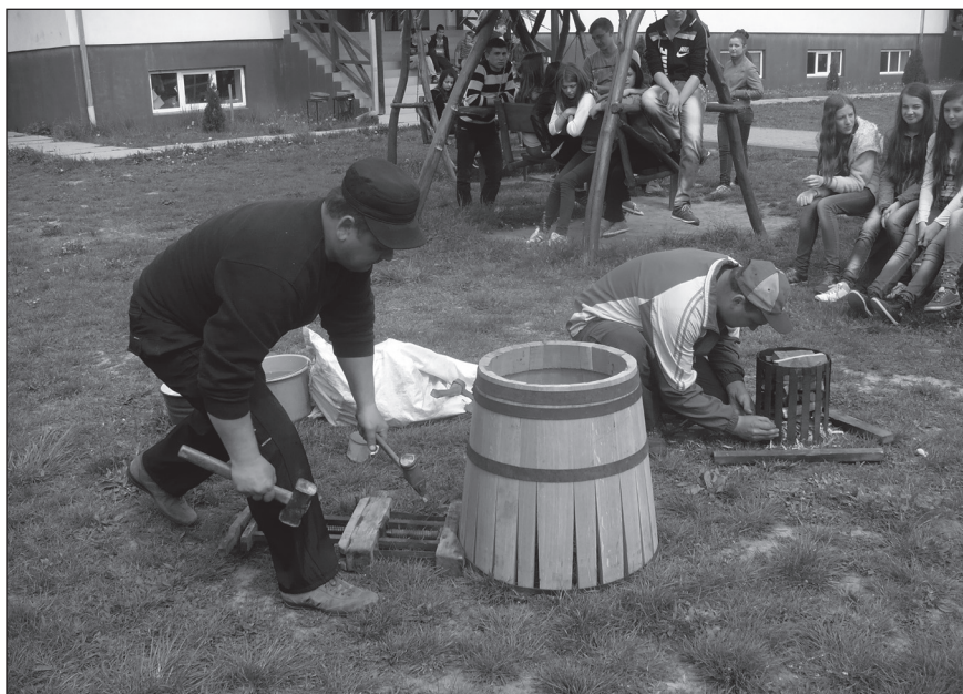
10. kép. Mikor a hordó szétnyílt felét teljesen összehúzták, megfordítják a hordót és ráverik az alsó összehúzó abroncsokat, megdolgozzák azt a felét is.
