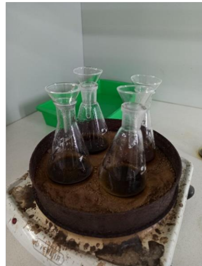
2. ábra A talajminták humusztartalmának meghatározása Tyurin-féle módszer szerint
