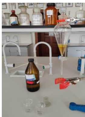
65.ábra: Vízben oldott szerves vegyületek extrakciója szerves oldószer hozzáadásával (2023.05.11.)
