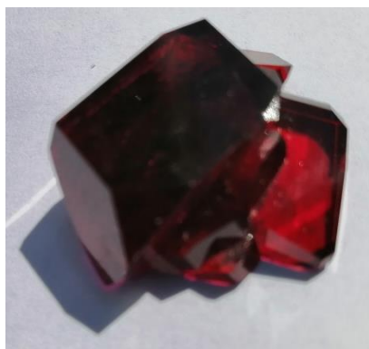
8. ábra. A \text{K}_2\text{Co}(\text{SO}_4)_2 \cdot 6\text{H}_2\text{O} egykristály (pH=4, C=0,5\text{mol}/\text{dm}^3 )
