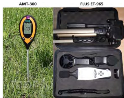
67. ábra. A levegő- és talajmikroklíma paramétereinek mérésére alkalmas műszerek
