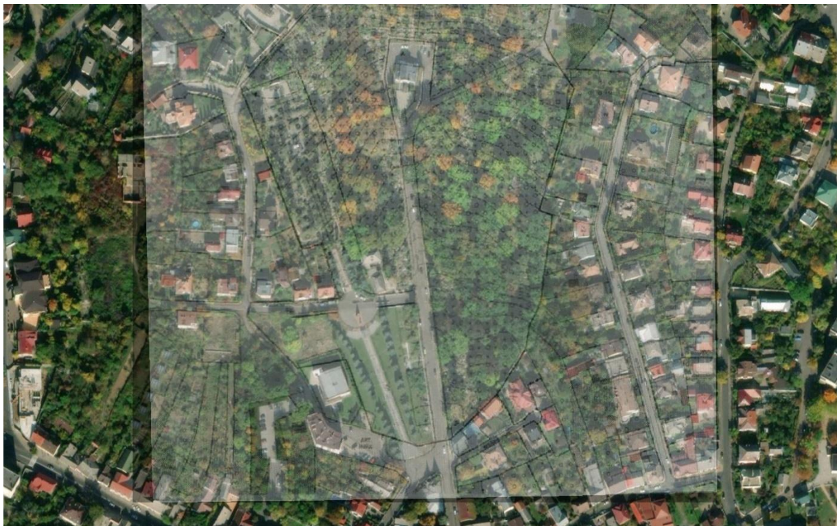
3. ábra. A kataszteri térkép (50% átlátszóság) és a Google Maps fedvények átfedése (részlet)
