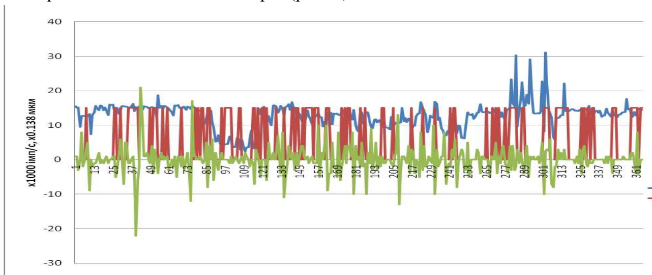
Рис. 1. Електромагнітна емісія (крива синього кольору), сейсмічність Закарпатського внутрішнього прогину (діаграма червоного кольору), кінематика рухів кори в зоні Оашського розлому (крива зеленого кольору) за 2019 рік.
