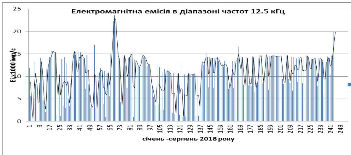
Рисунок 3. Електромагнітна емісія в діапазоні 12.5 кГц(діаграма синього кольору) за січень-серпень 2018 рік. Закарпатський внутрішній прогин.
