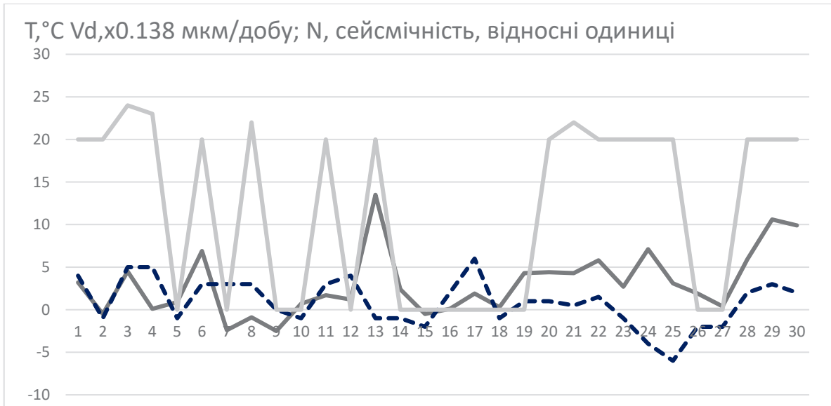
Рис. 8. Варіація температури повітря T (крива чорного кольору), швидкість зміни сучасних горизонтальних рухів кори (пунктирна крива чорного кольору), просторово-часовий розподіл місцевої сейсмічності (крива сірого кольору) в квітні 2021 року
