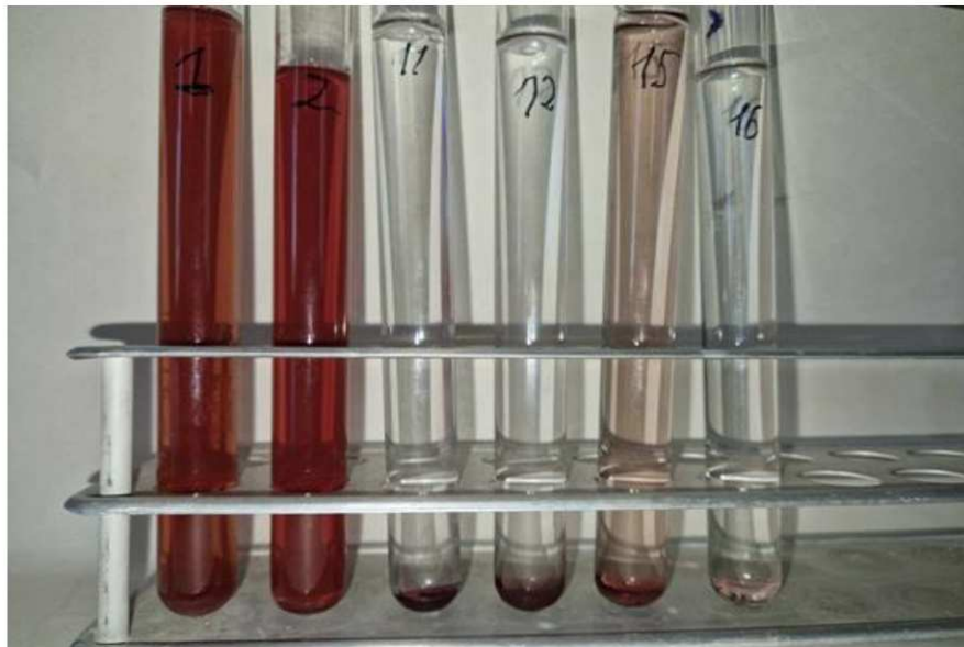
3.15. ábra. Réz szulfát oldatokból előállított nanorészecskéket tartalmazó oldatok
