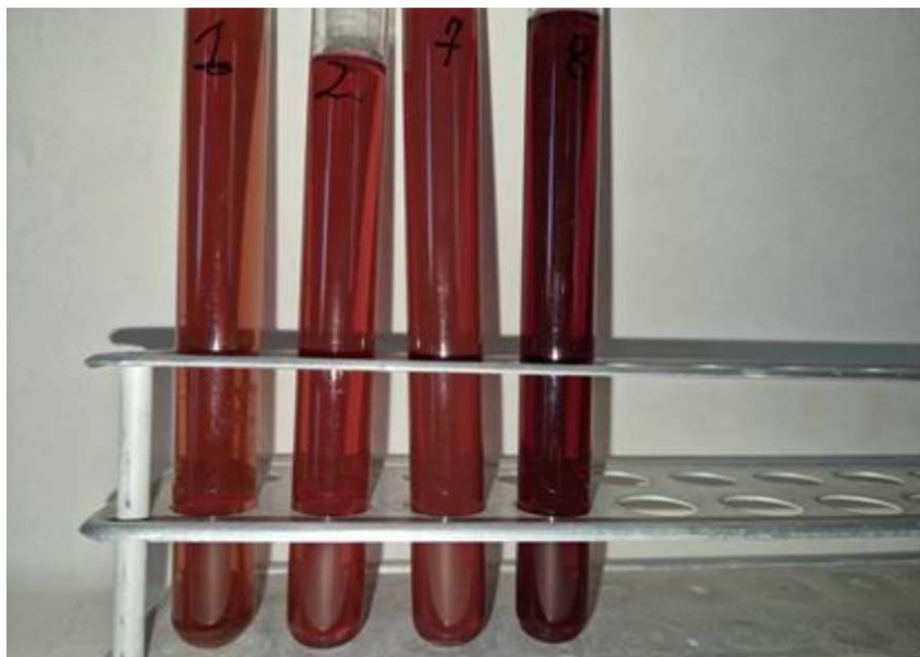
3.23. ábra. Réz-szulfát oldatok melynek pH-ját különböző oldatokkal állítottuk be 1. CuSO 4 + NaOH 0,01 20°C, 2. CuSO 4 + NaOH 0,01 50°C, 7. CuSO 4 + NH 4 OH 0,01 20°C 8. CuSO 4 + NH 4 OH 0,01 50°C (az oldatok 1 hét után)
