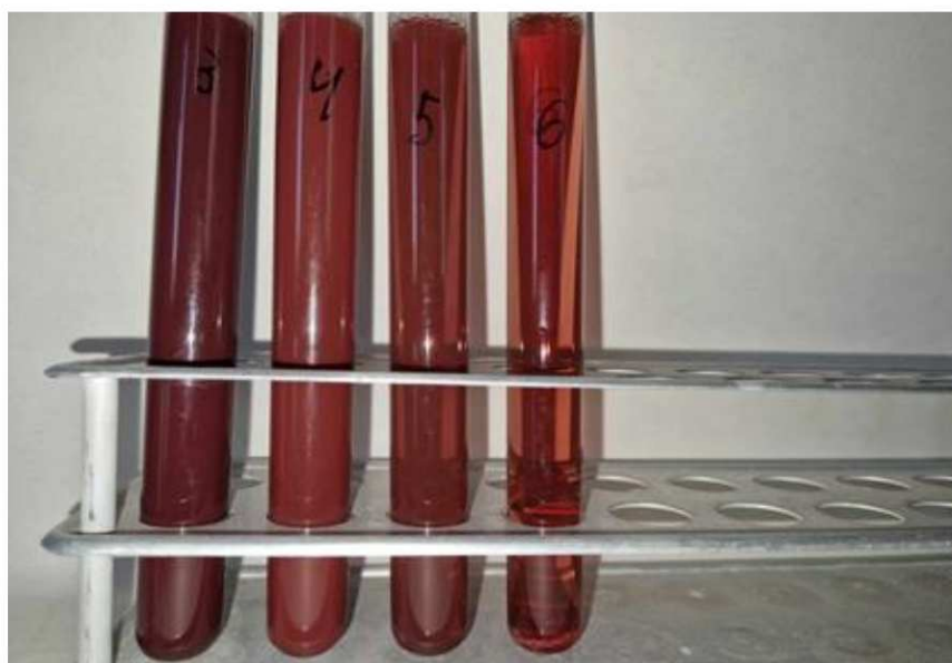
3.24. ábra. . Réz- klorid oldatok melynek pH-ját különböző oldatokkal állítottuk be 3. CuCl 2 + NaOH 0,01 20°C, 4. CuCl 2 + NaOH 0,01 50°C, 5. CuCl 2 + NH 4 OH 0,01 20°C, 6. CuCl 2 + NH 4 OH 0,01 50°C (az oldatok 1 hét után)
