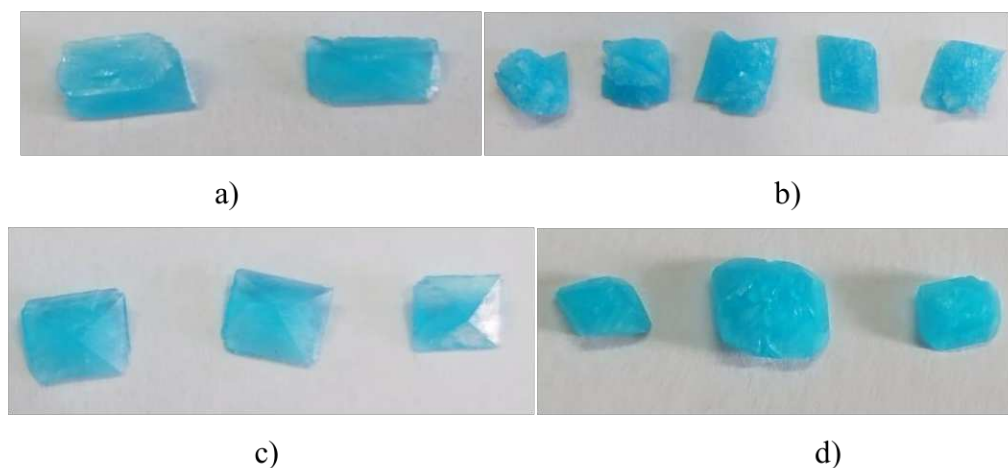
14. ábra Növesztett K 2 Cu(SO 4 ) 2 × 6H 2 O egykristályok: a) pH=1; b) pH=2; c) pH=3; d) pH=4
