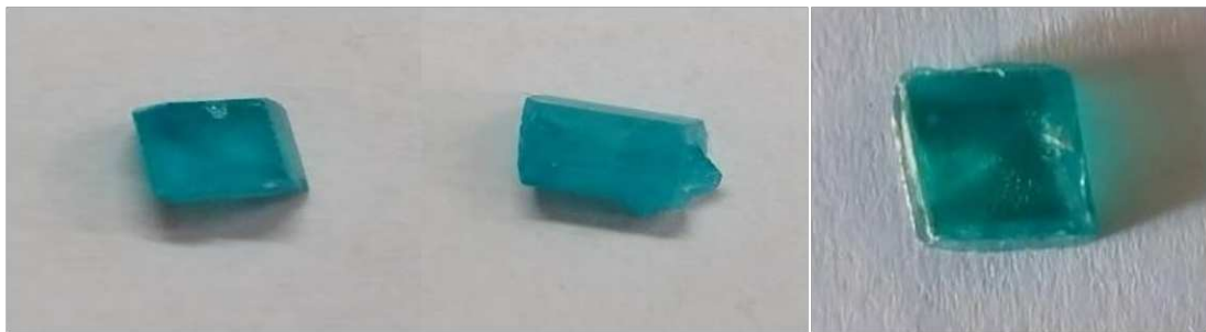
21. ábra A K_2Cu_{1-x}Ni_x(SO_4)_2 \times 6H_2O összetett kristályok általános formája: a) x=0,9 ; b) x=0,7 ; c) x=0,5 ; d) x=0,3 ; e) x=0,1
