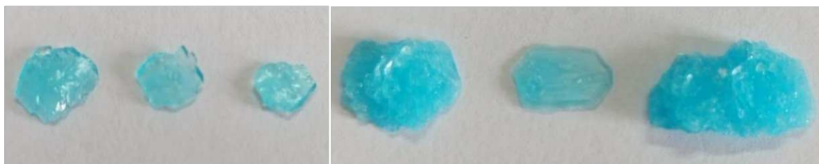
11. ábra A (\text{NH}_4)_2\text{Cu}(\text{SO}_4)_2 \times 6\text{H}_2\text{O} egykristályok 0,5 \text{ M} koncentrációban: a) \text{pH}=1 ; b) \text{pH}=2
