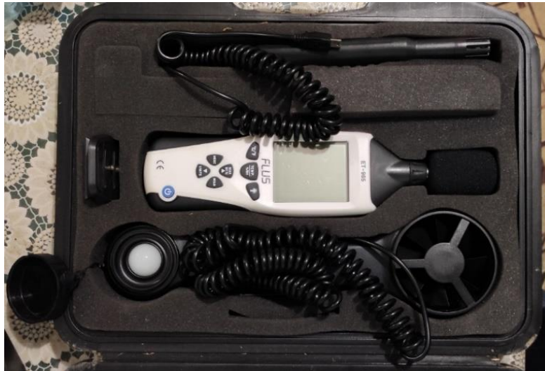
21. ábra. Flus ET-965 multifunkcionális mérőműszer (Forrás: Saját felvétel)
