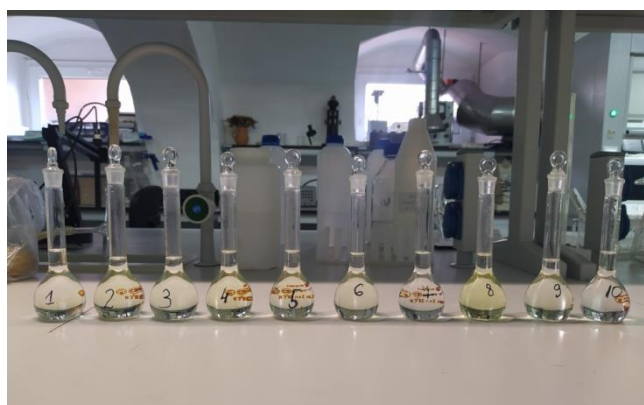
23. ábra A vizsgálathoz előkészített, roncsolt minták Saját forrás
